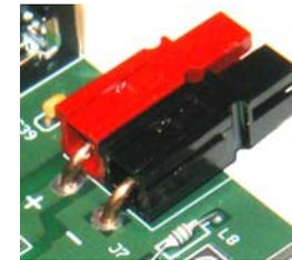
**Figure 25. Installing J7.**
