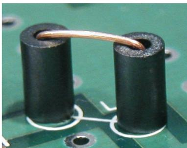
**Figure 20. Installing L7.**
