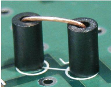
**Figure 20. Installing L7.**
