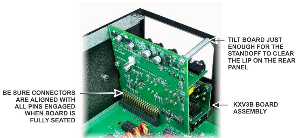
Figure 14. Installing KIO3/KIO3A Main Board.
