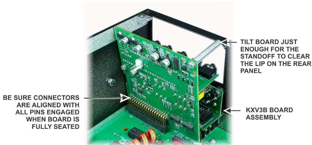
Figure 14. Installing KIO3/KIO3A Main Board.
