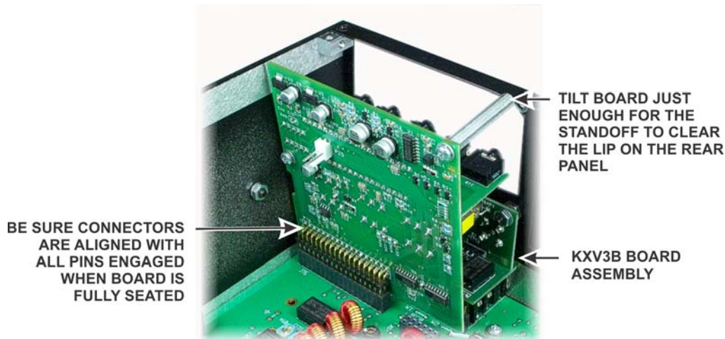
Figure 14. Installing KIO3/KIO3A Main Board.
